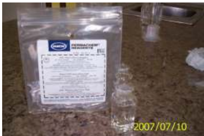
Fotografía No 8.- Reactivo utilizado para la medición de cloro libre residual.
